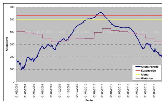
Fig. 3: Altura hidrométrica en Rosario para el período 2009 - 2010.
